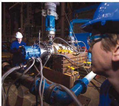
Модернизированный насос на испытаниях.
